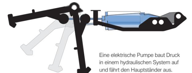
Eine elektrische Pumpe baut Druck in einem hydraulischen System auf und fährt den Hauptständer aus.
