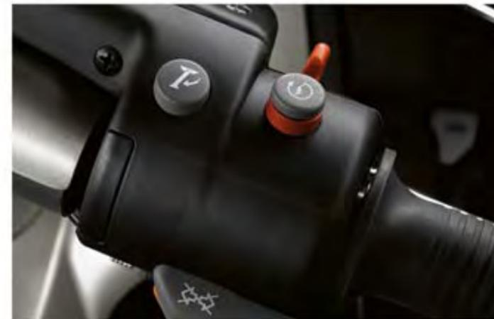
Die BMW K 1200 LT lässt sich mit Fahrer, Sozius und Beladung per Knopfdruck sicher aufstellen. Der elektrohydraulische Hauptständer wird an der rechten Lenkerseite betätigt.
