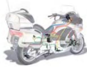
Die perfekt eingestellte Regelautomatik des BMW Motorrad Integral ABS (Vollintegral) ermöglicht in Kombination mit dem Druckmodulator eine maximale Verzögerung bei hervorragender Dosierbarkeit.
