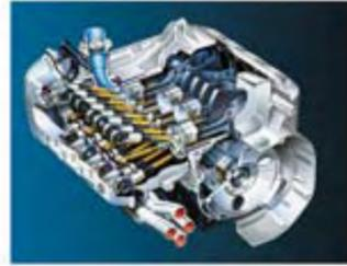
Im Schnittmodell werden die quer zur Fahrtrichtung eingebauten Kolben sichtbar. Beste Voraussetzungen für den Kardanantrieb, denn ein Umlenken der Antriebsbewegung ist nicht erforderlich.
